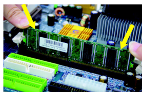
図 1 DIMM ソケットにはノッチがあり、DIMM メモリモジュールは一方向のみに挿入する必要があります。DIMM メモリモジュールを DIMM ソケットに垂直に挿入し、押し下げてください。
