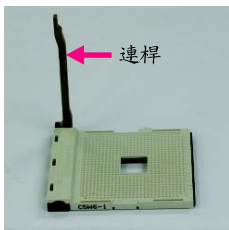
圖 1. 將中央處理器插座的連桿向上拉起至90度的位置。
