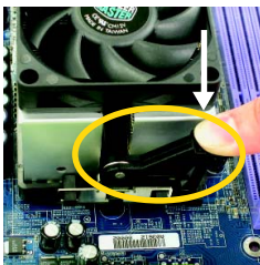
圖 4&5. 將散熱風扇配件一一組合
