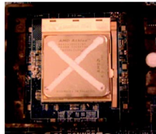
Abbildung 3. Auftragen von Thermalpaste an den Prozessor.
