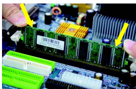
圖 1. 記憶體模組有一個凹痕，所以只能以一個方向插入。請扳開記憶體模組插槽卡榫，以雙手按在記憶體模組上邊兩側，以垂直向下平均施力的方式，將記憶體模組下壓推入插槽。
