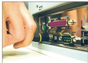
S/PDIF 同軸ケーブルを外部デコーダーに接続して、S/PDIF デジタルオーディオ信号を伝送します。
