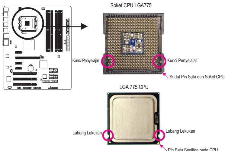
B. Ikuti langkah-langkah di bawah ini untuk menginstal CPU pada soket CPU dengan benar.
