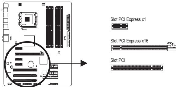
Ikuti langkah-langkah di bawah ini untuk memasang kartu ekspansi Anda dengan benar pada slot perluasan.
