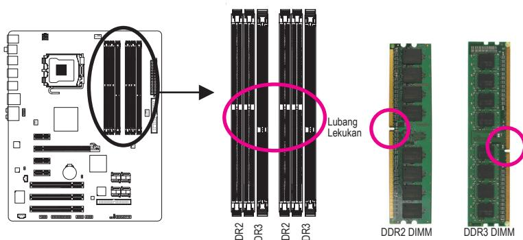
Sebuah modul memori DDR2/DDR3 tidak memiliki lubang lekukan, jadi modul ini hanya cocok dipasang pada satu arah saja. Ikatilah langkah-langkah di bawah ini untuk memasang modul-modul memori pada soket memorinya dengan benar.
