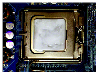
Rys. 1 Nałóż równą warstwę pasty termoprzewodzącej na powierzchnię zainstalowanego procesora.
