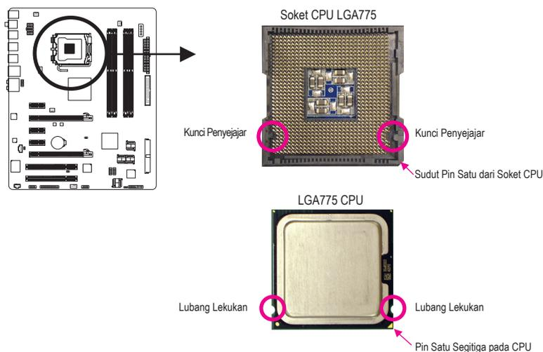
B. Ikuti langkah-langkah di bawah ini untuk menginstal CPU pada soket CPU dengan benar.
