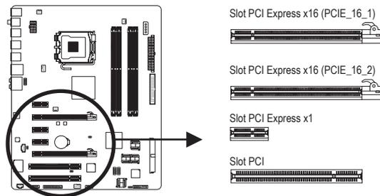
Ikuti langkah-langkah di bawah ini untuk memasang kartu ekspansi Anda dengan benar pada slot ekspansi.
