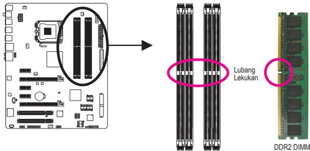
Sebuah modul memori DDR2 tidak memiliki lubang lekukan, jadi modul ini hanya cocok dipasang pada satu arah saja. Ikutilah langkah-langkah di bawah ini untuk memasang modul-modul memori pada soket memorinya dengan benar.
