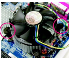
圖 3. 將散熱裝置的插梢對準主機板上的中央處理器腳座孔位，同時將斜對角的插梢用力向下壓。
