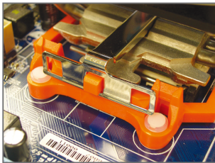
ขั้นที่ 3: เกี่ยวคลิปตัวระบายความร้อน CPU บนหัวยึดที่ด้านหนึ่งของโครงใส่ บนอีกด้านหนึ่ง กดคลิปตัวระบายความร้อน CPU ลงตรงๆ เพื่อเกี่ยวคลิปเข้ากับหัวยึดบน โครงใส่
