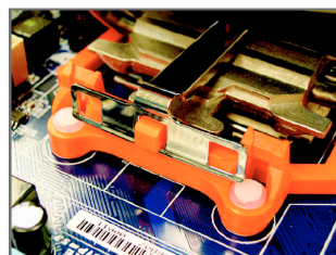
مرحله سوم: گیره خنک کننده را داخل پایه موجود بر روی یک طرف قاب نگه دارنده گیر بیندازید. طرف دیگر گیره خنک کننده را به صورت عمودی به سمت پایین فشار دهید و آن را داخل دیگر پایه موجود بر روی قاب نگه دارنده گیر بیندازید.
