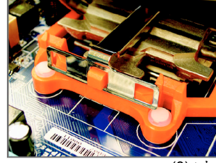
خطوة (3) قم بتركيب مشبك مبرد (مروحة) المعالج في هيكل التركيب البلاستيكي، ثم اضغط على مشبك مبرد (مروحة) المعالج من الجهة الأخرى ليتمكنك تركيبه في هيكل التركيب البلاستيكي
