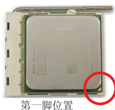
图 2. 将中央处理器第一脚 (小三角形记号处) 对齐插座上的三角型记号，再将中央处理器小心放入插座中，并确定所有针脚都已进入插槽内。 确定中央处理器完全插入定位后，一手按住中央处理器中间的位置，缓缓的将插座连杆向下压至锁住的位置。
