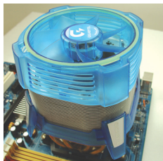
图 1. 在安装散热装置前，请先涂抹散热膏于中央处理器表面。接着将中央处理器专用的散热装置装好。(详细安装方式请参考散热装置的使用手册。)
