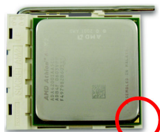
図 2 ソケット及び CPU 上のピン 1 の位置。 CPU ピンが対応する穴に完全に合うように、CPU を静かに配置します。CPU がソケットに配置されたら、一本の指を CPU 中央に添え、金属レバーを静かに押して、元の位置に戻します。
