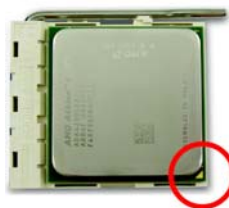
Abb. 2 Pin 1 Position auf dem Board und dem Prozessor. Bringen Sie die CPU vorsichtig in Position und gehen Sie sicher, dass die CPU Pins perfekt in ihren Löchern sitzen. Nachdem die CPU auf dem Sockel positioniert ist, legen Sie einen Finger auf die Mitte der CPU und drücken Sie den Metallhebel wieder vorsichtig in seine Originalposition.
