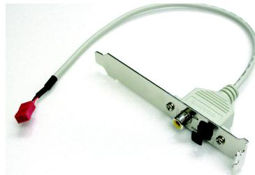
1. SPDIF 出力デバイスを PC のリアプラケットに装着し、ネジ止めします。
