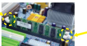
3. Зафиксируйте модуль памяти с обеих сторон пластмассовыми фиксаторами.
