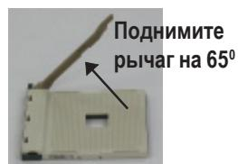
Рис.1. До угла в 65 градусов рычаг может подниматься с усилием, после этого продолжайте поднимать его до угла в 90 градусов, пока не услышите щелчок.
