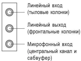
➤ После установки драйвера встроенного аудиоконтроллера к линейному выходу можно подключать колонки, а к микрофонному входу - микрофон. К линейному входу можно подключать, например, выход CD-ROM или переносного аудиоплеера.
