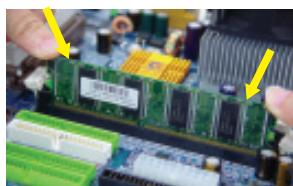
2. Вставьте модуль памяти DIMM в разъём вертикально.
