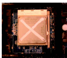
図4. 感熱糊をプロセッサに塗る
