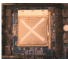
Рис.4. Нанесение термопасты на поверхность процессора.
