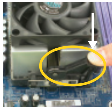
Рис. 5, 6. Совмещение теплоотвода с выступами процессорного разъема.
