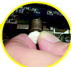
AGP カードのインストール・取外しの際は、AGP スロットの端にある白いバーを静かに引き出してください。AGP カードをオンボードの AGP スロットに合わせ、確実に中に差してください。ご使用になる AGP カードが小さな白いバーによってロックされたことを確認してください。
