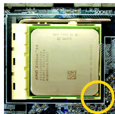
Abb. 2 Ein goldfarbenes Dreieck kennzeichnet eine Ecke der CPU. Bitte stimmen Sie diese Ecke mit der Sockelecke, die dem CPU Hebel am nächsten liegt, ab. Bringen Sie die CPU vorsichtig in Position und gehen Sie sicher, dass die CPU Pins perfekt in ihren Löchern sitzen. Nachdem die CPU auf dem Sockel positioniert ist, legen Sie einen Finger auf die Mitte der CPU und drücken Sie den Metallhebel wieder vorsichtig in seine Originalposition.
