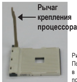
Рис.3. Найдите первые контакты разъема и процессора. Осторожно нажмите на центральную часть процессора и опустите рычаг крепления в крайнее нижнее положение.
