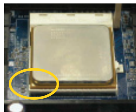
Рис.3. Найдите первые контакты разъема и процессора. Осторожно нажмите на центральную часть процессора и опустите рычаг крепления в крайнее нижнее положение.
