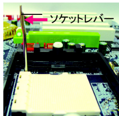
図 1 レバーを 90 度角に配置します。
