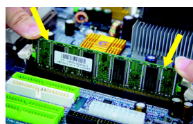
図 1 DIMM ソケットにはノッチがあり、DIMM メモリモジュールは一方向のみに挿入するようになっています。DIMM メモリモジュールを DIMM ソケットに垂直に挿入し、押し下げてください。
