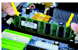
Abb. 1 Die DIMM Fassung hat eine Kerbe, so dass das DIMM Speichermodul nur in eine Richtung passen kann. Führen Sie das DIMM Speichermodul senkrecht in die DIMM Fassung ein. Dann drücken Sie es nach unten.
