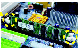
Abb. 2 Schließen Sie die Plastikklammer an beiden Kanten der DIMM Fassungen, um das DIMM Modul zu verriegeln. Kehren Sie die Installationsschritte um, wenn Sie das DIMM Modul entfernen wollen.
