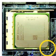
図 2 ソケット及びプロセッサ上のピン 1 の位置。 CPU ピンが対応する穴に完全に合うように、CPU を静かに配置します。CPU がソケットに配置されたら、一本の指を CPU 中央に添え、金属レバーを静かに押して、元の位置に戻します。
