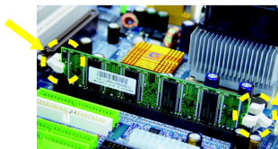
図 2 DIMM ソケットの両側にあるプラスチックのクリップを閉じて、DIMM モジュールを固定します。DIMM モジュールを取り外すにはインストールと逆の手順で行います。
