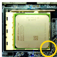
Abb. 2 Ein goldfarbiges Dreieck ist am Rand der CPU markiert. Richten Sie bitte diesen Rand mit dem Rand der Einfassung aus, der dem CPU Hebel am nächsten ist. Setzen Sie die CPU leicht in Position. Überprüfen Sie, dass die CPU Stifte genau in ihre Löcher passen sobald die CPU in die Einfassung eingesetzt ist, legen Sie einen Finger auf die Mitte der CPU und bewegen Sie den Metallhebel behutsam zurück in seine Ausgangsstellung.
