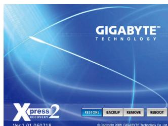
システムが故障した場合、RESTORE を選択してハードドライブへのバックアップを復元します。それまでバックアップが作成されていない場合、RESTORE オプションは表示されません。
