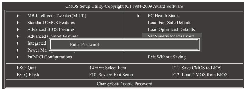
このアイテムで <Enter> を押して 8 文字以内でパスワードを入力し、<Enter> を押します。パスワードを確認するように求められます。パスワードを再入力し、<Enter>を押します。
