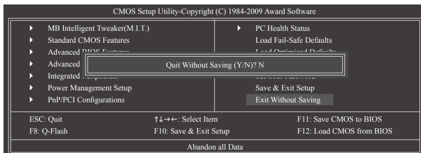
このアイテムで **<Enter>** を押し、**<Y>** キーを押します。これにより、CMOS に対して行われた BIOS セットアップへの変更を保存せずに、BIOS セットアップを終了します。**<N>** または **<Esc>** を押して、BIOS セットアップメインメニューに戻ります。
