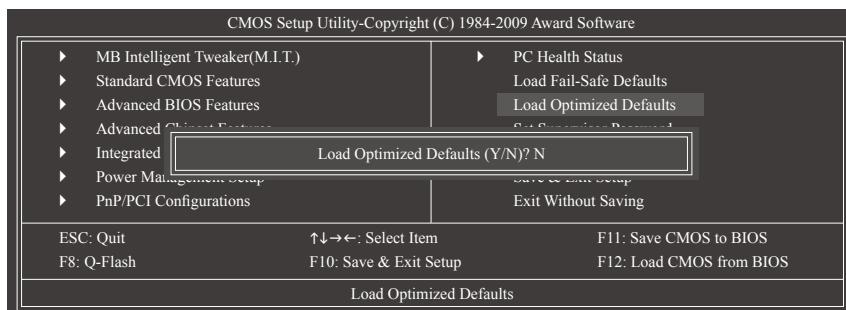
このアイテムで <Enter> を押し <Y> キーを押すと、最適な BIOS 既定値設定がロードされます。BIOS 既定値設定により、システムは最適の状態で作動します。BIOS を更新した後、または CMOS 値を消去した後、最適化既定値を常にロードします。
