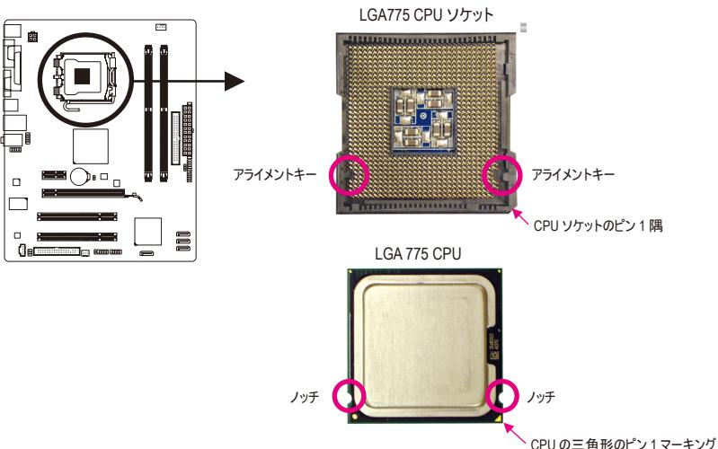
B. 以下のステップに従って、CPUをマザーボードのCPUソケットに正しく取り付けてください。
