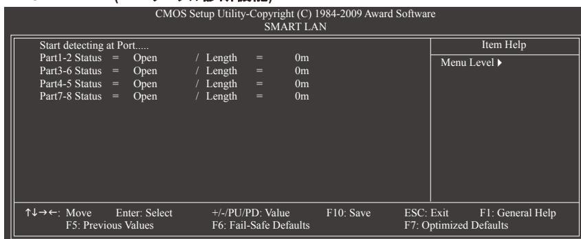
このマザーボードは、付属の LAN ケーブルのステータスを検出するために設計されたケーブル診断機能を組み込んでいます。この機能は、配線問題を検出し、障害またはショートまでのおおよその距離を報告します。LAN ケーブルの診断については、以下の情報を参照してください：
