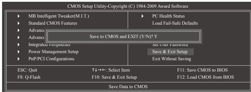
このアイテムで **<Enter>** を押し、**<Y>** キーを押します。これにより、CMOS が変更され、BIOS セットアッププログラムを終了します。**<N>** または **<Esc>** を押して、BIOS セットアップメインメニューに戻ります。
