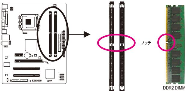
DDR2 メモリモジュールにはノッチが付いているため、一方向にしかフィットしません。以下のステップに従って、メモリソケットにメモリモジュールを正しく取り付けてください。
