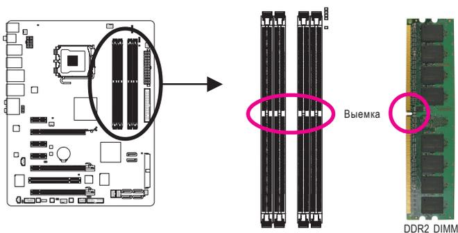
Модули памяти DDR2 имеют выемку, не позволяющую установить их в неправильном положении. Для правильной установки модулей памяти в разъемы следуйте приведенным ниже инструкциям.
