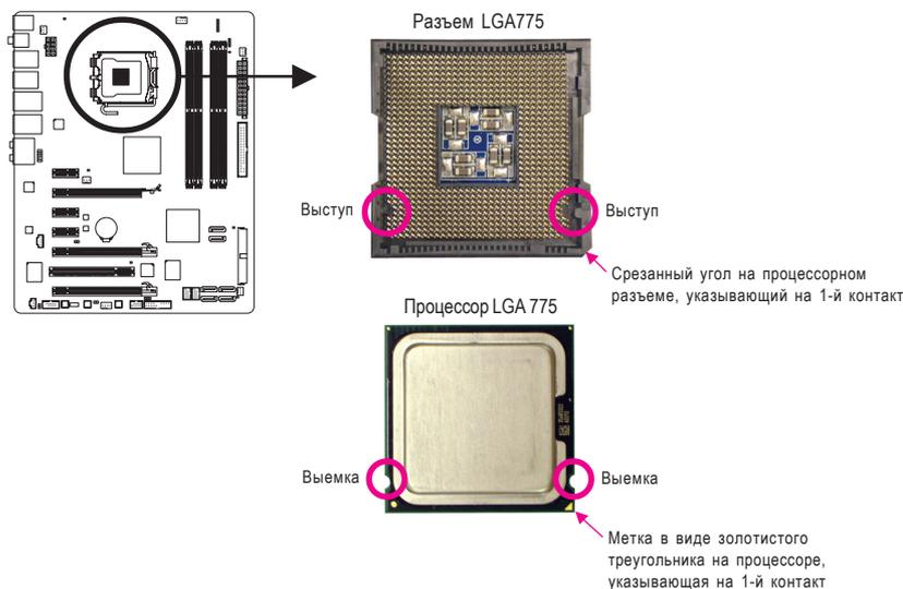
В. Для установки процессора в процессорный разъем системной платы выполните следующие действия:
