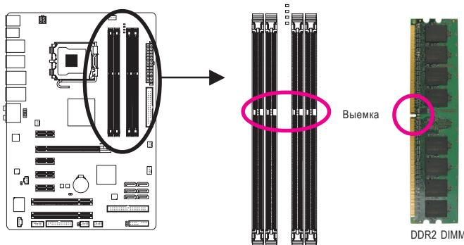
Модули памяти DDR2 имеют выемку, не позволяющую установить их в неправильном положении. Для правильной установки модулей памяти в разъемы следуйте приведенным ниже инструкциям.
