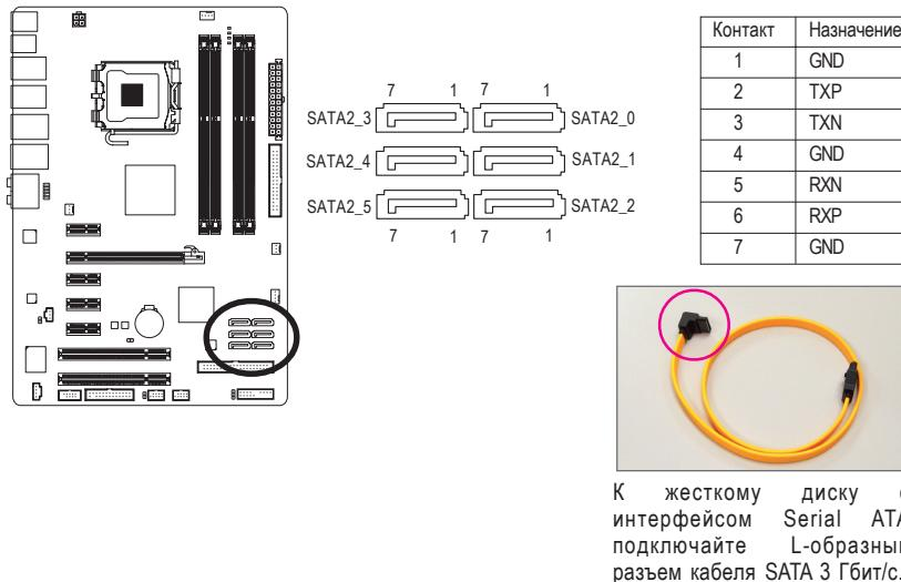
К жесткому диску с интерфейсом Serial ATA подключайте L-образный разъем кабеля SATA 3 Гбит/с.
