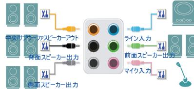
統合された HD (ハイディフィニション) オーディオにジャック再タスキング機能が搭載されているため、ユーザーはオーディオドライバを通して各ジャックの機能を変更することができます。たとえば、4 チャンネルオーディオ
