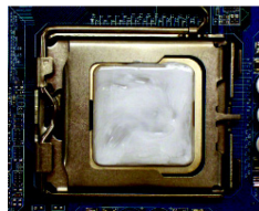
Abb. 1 Tragen Sie eine regelmäßige Schicht von Kühlpaste auf die Oberfläche der installierten CPU auf.
