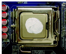
Abb. 1 Tragen Sie eine gleichmäßige Schicht von Kühlpaste auf die Oberfläche der installierten CPU auf.
