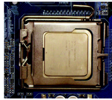
Şek. 4 CPU düzgün takıldığında, lütfen yükleme plakasını yerleştirin ve metal kolu ilk yerine geri itin.
