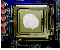
Şek.1 Takılan CPU'nun yüzeyine lütfen ısı macunu sürün.
