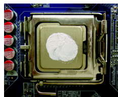
Figura 1 Applicare uno strato uniforme di pasta termica sulla superficie della CPU installata.
