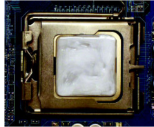
그림 1 설치된 CPU 의 표면에 써멀-그리스를 바르십시오.
