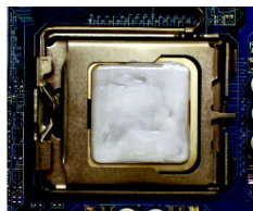
Abb. 1 Tragen Sie eine gleichmäßige Schicht von Wärmepaste auf die Oberfläche der installierten CPU auf.
