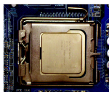
Abb. 4 Nach dem richtigen Installieren der CPU bringen Sie die Ladeplatte wieder an und bewegen Sie den Metallhebel zurück in seine Ausgangsstellung.
