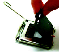
Şek. 2 CPU soketindeki plastik kaplamayı çıkarın.
