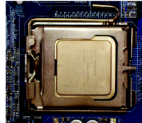
Şek. 3 CPU soketinin kenarındaki küçük altın renkli üçgeni bulun. CPU'nun amaçlanan köşesini üçgen ile hizalayın ve CPU'yu yavaşça konumuna getirin.
