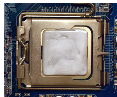
Рис. 1 Нанесите на поверхность процессора равномерный слой термопасты.
