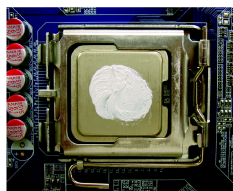
図 1 取り付けられた CPU 表面に CPU クーラーペーストを均一に塗ります。
