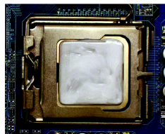
Abb. 1 Tragen Sie eine regelmäßige Schicht von CPU-Kühler Paste auf die Oberfläche der installierten CPU auf.
