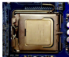
図 4 CPU が適切に挿入された後、ロードプレートを手元に戻し、金属レバーを元の位置に押し戻します。
