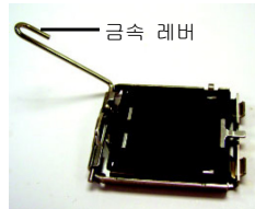
그림 1 CPU 소켓에 있는 금속 레버를 천천히 똑바로 들어 올리십시오.
