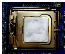
그림 1 설치된 CPU 의 표면에 써멀-그리스를 바르십시오.
