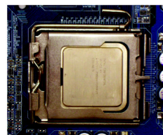
그림 4 CPU 를 올바르게 설치했으면, 로드 플레이트를 제자리에 놓고 금속 레버를 원래의 위치에 고정되도록 누르십시오.
