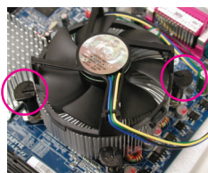
Рис. 3 Разместите теплоотвод на процессоре. Убедитесь, что крепежные штырьки расположены над отверстиями в системной плате. Нажмите на головки штырьков, расположенных по диагонали один относительно другого.
