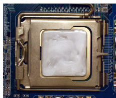
Рис. 1 Нанесите на поверхность процессора равномерный слой термопасты.
