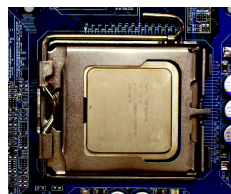
Fig. 4 Quando a CPU estiver devidamente instalada, reponha a placa de carga e empurre a alavanca metálica para que esta retome a sua posição original.
