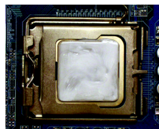
그림 1 설치된 CPU 의 표면에 써멀-그리스를 바르십시오.
