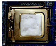
Abb. 1 Tragen Sie eine regelmäßige Schicht von CPU-Kühlers paste auf die Oberfläche der installierten CPU auf.
