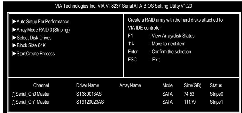
4. 若在步驟2您選擇的是RAID 0陣列, 則需設定此Block size. 設定磁碟區塊大小. 視窗畫面顯示出可使用的磁區大小4k~64k.
