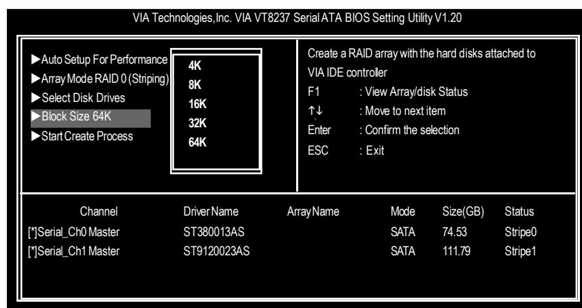
5. 選擇 Start Create Process 並按下 <Enter>確定. 會出現要求確定的訊息,按下 Y 完成 RAID 硬碟系統設定, 按 N 取消建立 RAID 硬碟系統設定.
