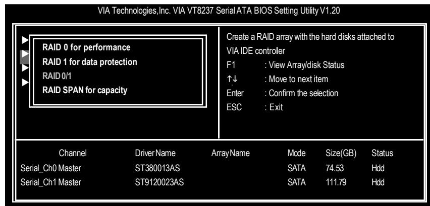
3. 在選擇陣列模式後,這裡有兩種方法建立磁碟陣列.**Auto Setup**或**Select Disk Drives**(手動安裝設定). **Auto Setup**會自動選擇並建立陣列,但無法建立RAID1的**Create and duplicate**模式陣列.此指令會設所有的磁碟為全新的一個. **Select Disk Drives**可以依照您的需求設定陣列.選擇**Select Disk Drives**並按下<Enter>確定,以方向鍵設定欲使用的硬碟,被設定的硬碟前會有\*的符號.
