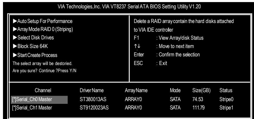
除了 RAID 1 陣列外, 刪除陣列時硬碟資料將會被毀壞. 當 RAID 1 陣列被刪除時, 2 個硬碟機的資料將會被保留並變成一般的硬碟機使用.
