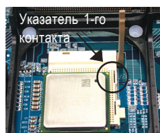
Рис. 4. Найдите первый контакт в разъеме и срезанный (позолоченный) угол на верхней поверхности процессора. Вставьте процессор в разъем.
