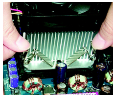
Abb. 1 Befestigen Sie den Kühlkörper an den CPU-Sockel am Motherboard.
